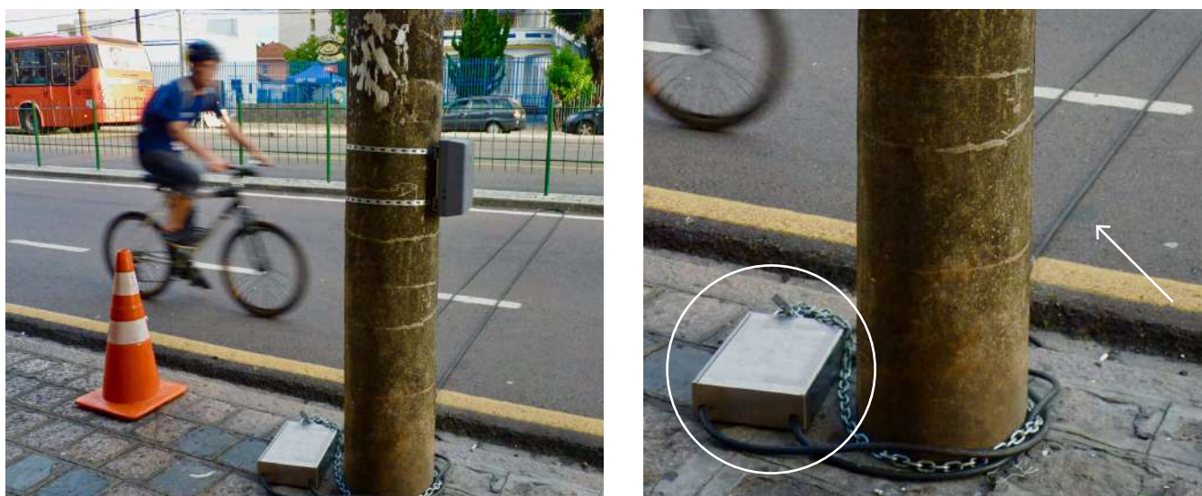
Figura B.15: Contador automático de ciclista, com tecnologia pneumática, instalado em via em Curitiba - PR, 2014 (mesmo local da Figura B.13). As duas mangueiras no asfalto compõem o sensor de bicicletas, conforme demonstra a seta indicativa no detalhe à direita.
